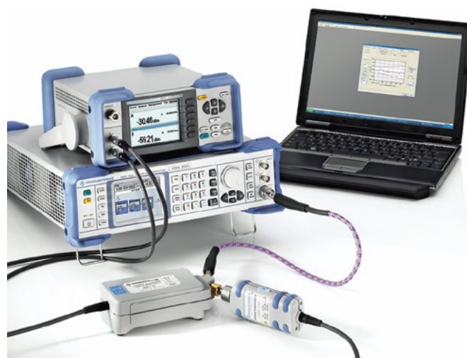
Измерительная установка для калибровки преобразователя мощности NRP-Z55
