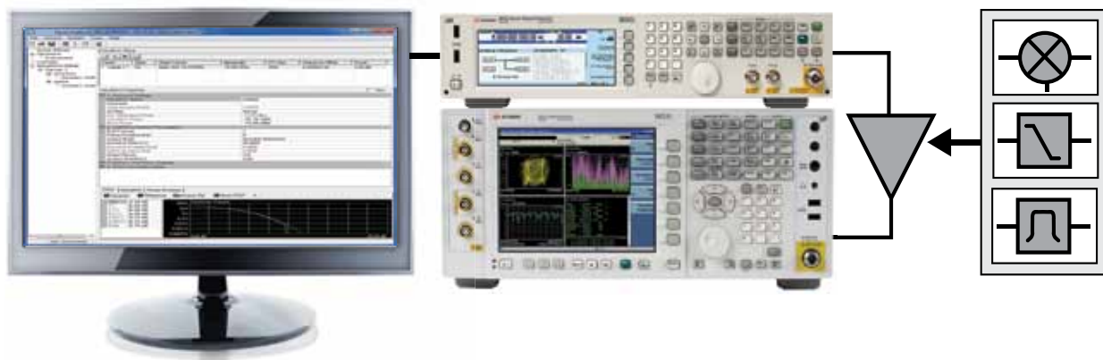
Рис. 1. Типовая схема тестирования, использующая базовые возможности Signal Studio с генератором и анализатором сигналов серии Keysight X.
