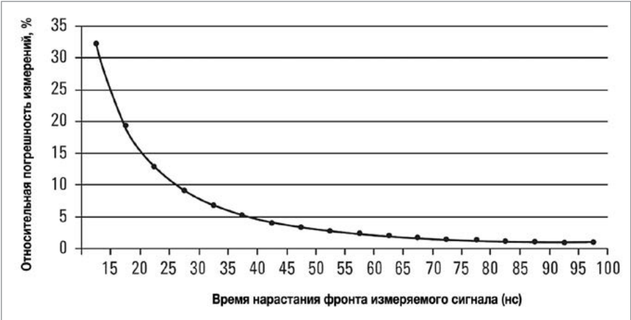
Рисунок 1. Ошибка измеренного времени нарастания в зависимости от времени нарастания измеряемого сигнала
