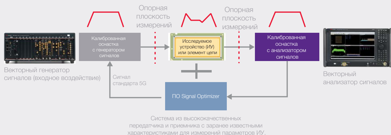
Рисунок 2. Схема стенда для испытаний устройств стандарта 5G на основе измерительных приборов и программного обеспечения, адаптированных для 5G NR, включая программное обеспечение Signal Optimizer.
