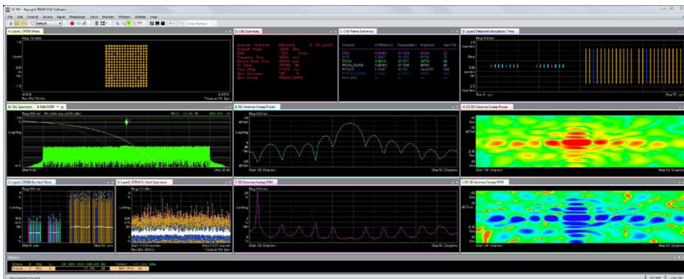
Рис. 3. Анализ сигналов стандарта 5G NR с модуляцией 256 QAM и диаграммы направленности антенны
