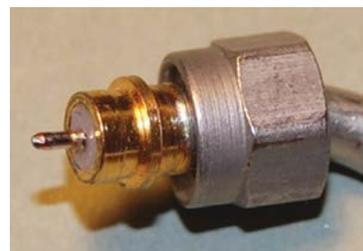
Рисунок 7. На рисунке 7а показан переход с 2,4 мм на 3,5 мм, причём соединитель 2,4 мм расположен справа. Справа от него показана вилка SMA. Вилка SMA на рисунке 7б имеет съёмную гайку и смещенный по оси (слишком длинный) и слегка изогнутый центральный вывод, вероятно, из-за подключения к соединителю полужесткого кабеля.
