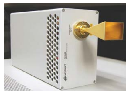
Рисунок 4. Сверхширокополосный понижающий преобразователь миллиметрового диапазона компании Keysight Technologies. В правой верхней части виден волноводный вход с рупорной антенной. Этот понижающий преобразователь использует сигнал внешнего СВЧ-гетеродина, а его выходной сигнал подаётся на внешний дискретизатор, например, на осциллограф.
