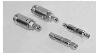
Рисунок 6. При работе с сигналами миллиметрового диапазона часто применяются защитные переходы с соединителями «розетка-розетка». Здесь показаны переходы для подключения анализатора с входными соединителями 2,4 мм к принадлежностям, имеющим соединители типов N и 2,4 мм.
