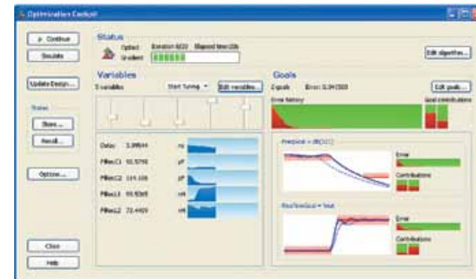
Рис. 3. Окно оптимизации. Это новая интерактивная среда, предоставляющая доступ к многочисленным переменным и целевым показателям оптимизации. Она позволяет управлять ходом процесса оптимизации и настраивать его в интерактивном режиме.
