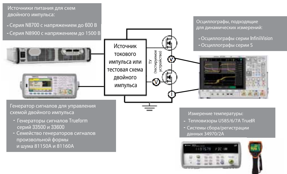
Рисунок 3. Описание компоновки и размещения приборов для динамического тестирования или тестирования с использованием двойного импульса
