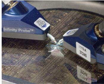
Измерение X-параметров на основной частоте
