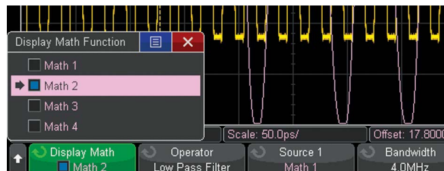
Рис. 32. Осциллографы серии 4000 X позволяют создавать до четырех математических функций с одной результирующей функцией, отображаемой на дисплее.
