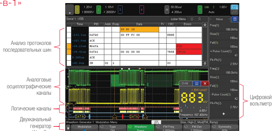
Рис. 17. Осциллографы серии 4000 X обеспечивают возможность органичной интеграции семи приборов в одном.
