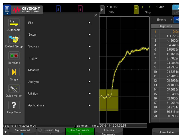
Рис. 14. Использование выпадающего меню Keysight для управления, принятого в операционной системе Windows.
