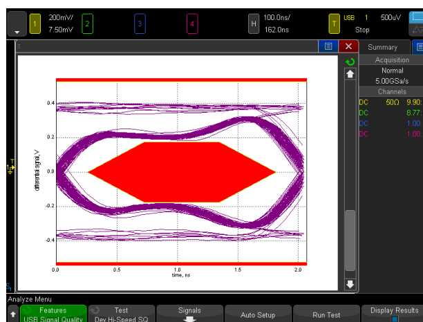
Рис. 28. Выполнение автоматического тестирования качества сигналов низкоскоростной, полноскоростной и высокоскоростной шины USB 2.0.
