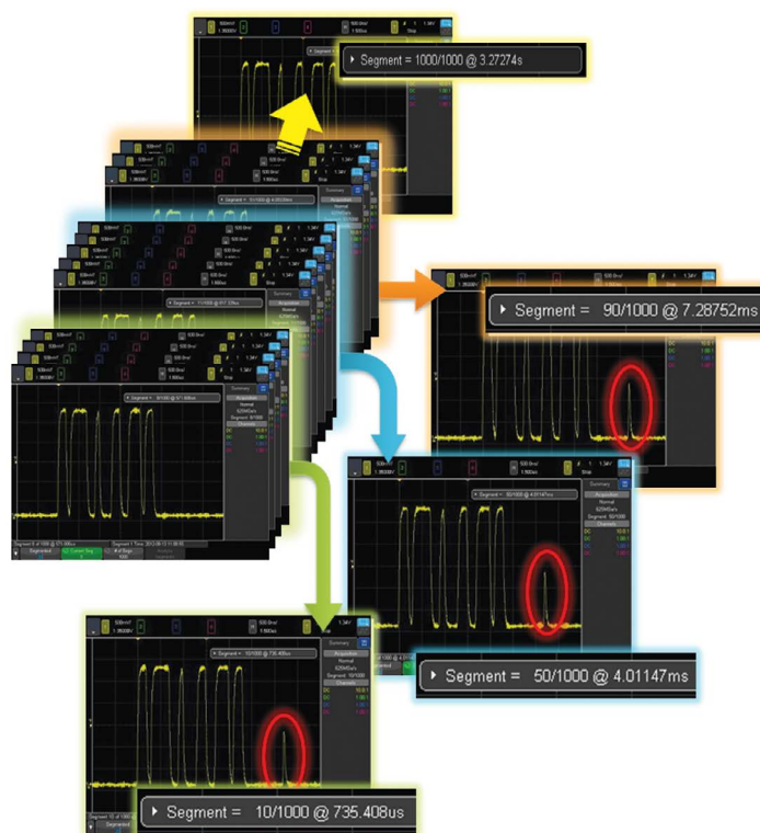
Рис. 7. Режим сегментированной памяти обеспечивает более эффективное использование памяти при захвате до 1 000 представляющих интерес фрагментов сигнала, что позволяет превратить прибор в осциллограф со сверхглубокой памятью, который может легко захватывать редкие события и аномалии.
