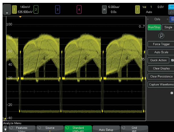
Рис. 27. Синхронизация по сигналу HDTV формата 1080p.
