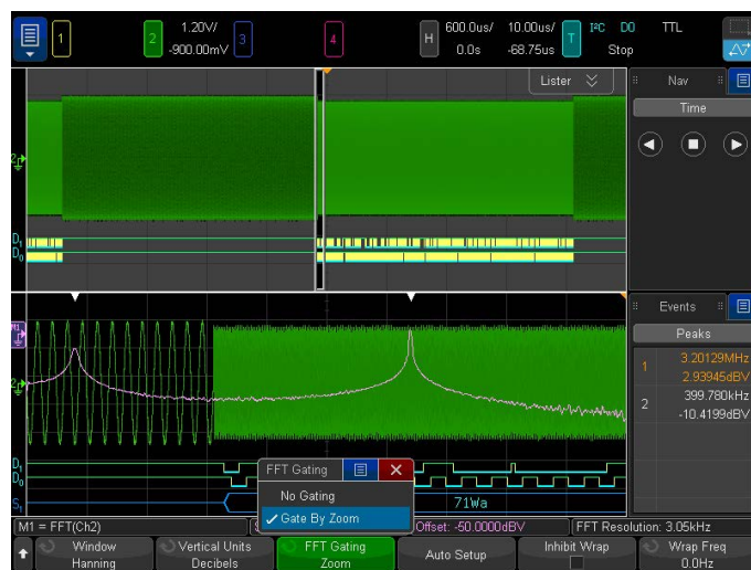
Рис. 18. Функция стробированного БПФ позволяет установить корреляцию между скачкообразной перестройкой частоты сигнала с FSK модуляцией, аналоговым сигналом и управляющим сигналом шины I 2 C.
