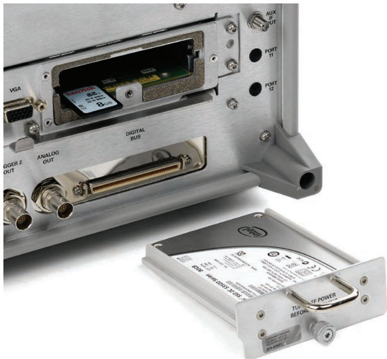
Съемные твердотельный накопитель и карта памяти обеспечивают повышенную безопасность.
