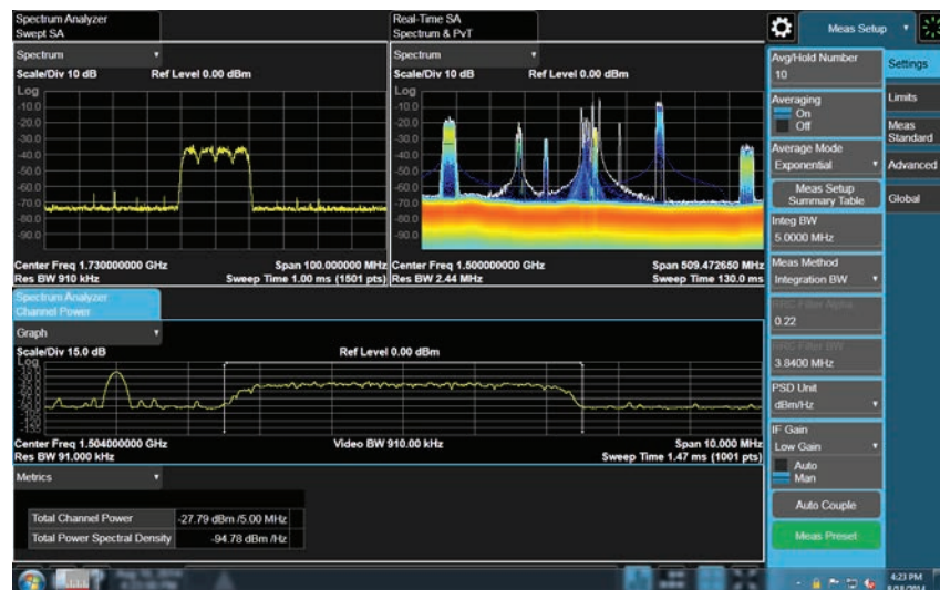
В UXA оптимизирована структура меню и обеспечиваются гибкие возможности отображения результатов измерений.
