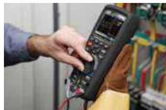
Встроенный цифровой осциллограф и функции FFT
