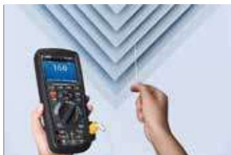
Измерение температуры термопарой типа К
