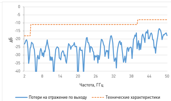
Рисунок 3-18 Keysight U7227F, зависимость потерь на отражение по выходу от частоты (типовая)
