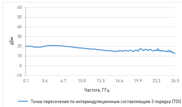
Рисунок 3-14 Keysight U7227C, зависимость точки пересечения по интермодуляционным составляющим 3 порядка (TOI) от частоты (типичная)
