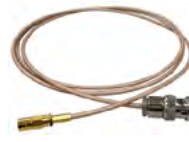
Кабель канала запуска для измерителя мощности с термовакuumной опцией с соединителями BNC (вилка) – SMB (розетка), 50 Ом, 1,5 м (2 шт.) (для опции TVA)
