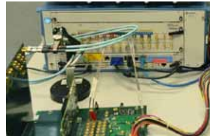
Рисунок 8. Схема измерения допустимого джиттера с помощью J-BERT M8020A.
