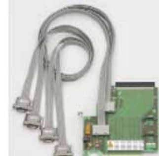
Рисунок 18. Пробники с промежуточной шиной серии N4240 используют технологию Soft Touch для снижения влияния на исследуемые сигналы.
