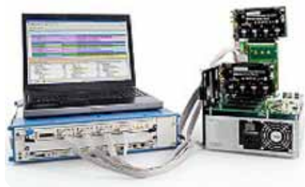
Рисунок 14. Всесторонняя проверка разрабатываемого устройства на отладчике протокола Keysight.
