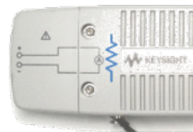
Рис. 28. Малосигнальное добавочное сопротивление
