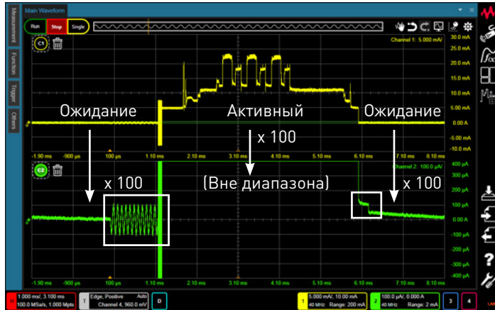
Рис. 13. Измерение с широким динамическим диапазоном с использованием двухканального датчика тока CX1102A
