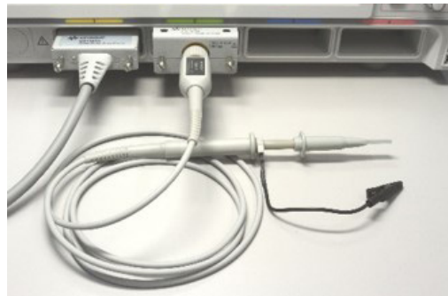
Рис. 7. Приборы серии CX3300 также могут измерять и отображать формы кривых напряжения с помощью пассивного пробника: это позволяет просматривать кривые динамической мощности наряду с кривыми тока.
