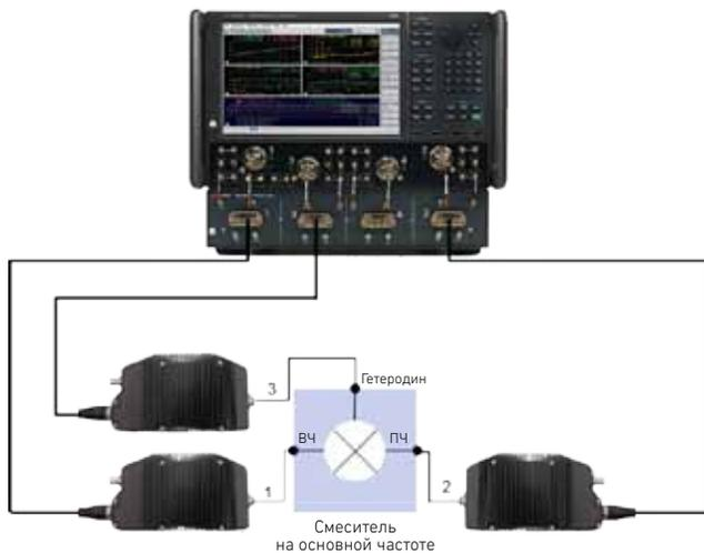
PNA с двумя источниками, четырехпортовым контроллером N5292A и модулями расширения диапазона частот позволяет измерять характеристики смесителей и преобразователей в СВЧ-диапазоне. Второй источник PNA подает сигнал гетеродина на смеситель.
