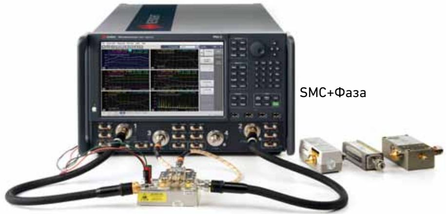
Приложение S93083A – скалярный смеситель/преобразователь плюс управление фазой (SMC+Phase) – упрощает схемы измерения характеристик смесителя и преобразователя, так как эталонные и калибровочные смесители не требуются. Калибровка упрощена за счет использования трех широкополосных компонентов: измерителя мощности в качестве стандарта амплитуды, генератора комбинационных частот в качестве стандарта фазы и калибровочного комплекта S-параметров (механический или электронный модуль калибровки).
