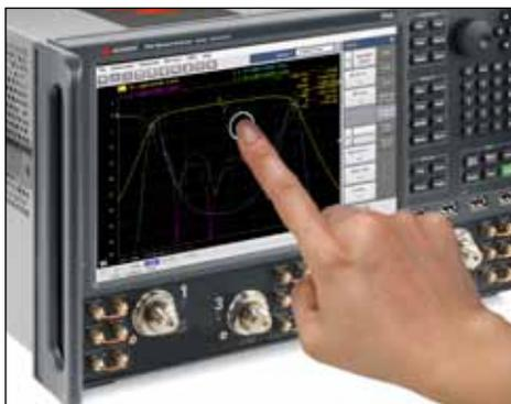
Все модели PNA оснащены сенсорным дисплеем высокого разрешения, который обеспечивает четкое изображение и простой доступ ко всем данным и трассам. Такое усовершенствование интерфейса пользователя облегчает работу и ускоряет подготовку сложных измерений.
