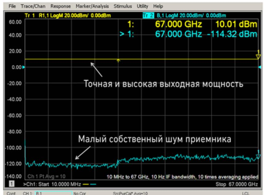
Благодаря регулируемой выходной мощности источника до +10 дБм и собственному уровню шумов приемника -114 дБм, PNA обеспечивает типовой динамический диапазон 124 дБ на частоте 67 ГГц, что шире, чем у любого другого анализатора цепей в этом диапазоне частот.
