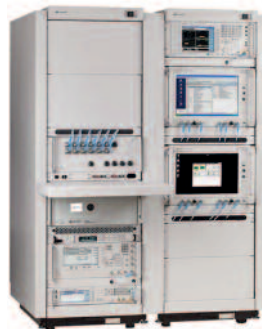
T4010S система сертификационного тестирования средств беспроводной связи
