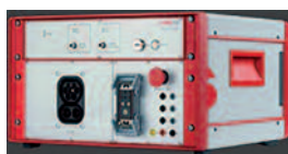
ScienLab CDS – система для тестирования зарядных станций и электромобилей по стандартам IEC 61851 / DIN SPEC 70120 / ISO 15118 / CHAdeMO / GB/T
