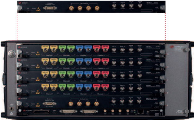
Вид передней панели системы, включающей 16 синхронизированных каналов (4 модуля M8195A и 1 модуль M8197A)
