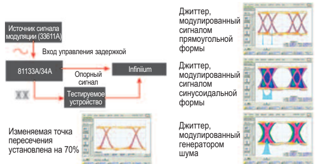
Эмуляция реальных сигналов путём добавления джиттера к тактовым сигналам или сигналам данных, используя вход управления задержкой
