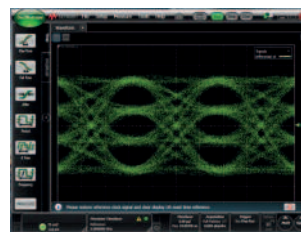
Сигнал PAM-4, генерируемый на скорости 56 Гбод
