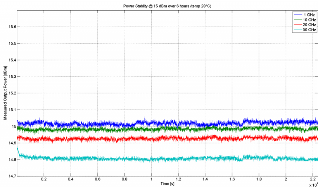
Рисунок 2. Стабильность выходной мощности на сетке частот до 30 ГГц, уровень +15 дБм
