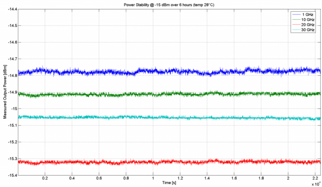
Рисунок 3. Стабильность выходной мощности на сетке частот до 30 ГГц, уровень -15 дБм
